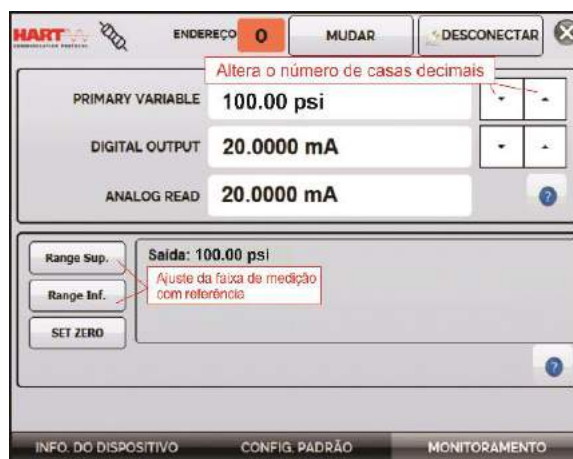
Fig. 67 - Ajuste da faixa de medição do transmissor HART® com referência
