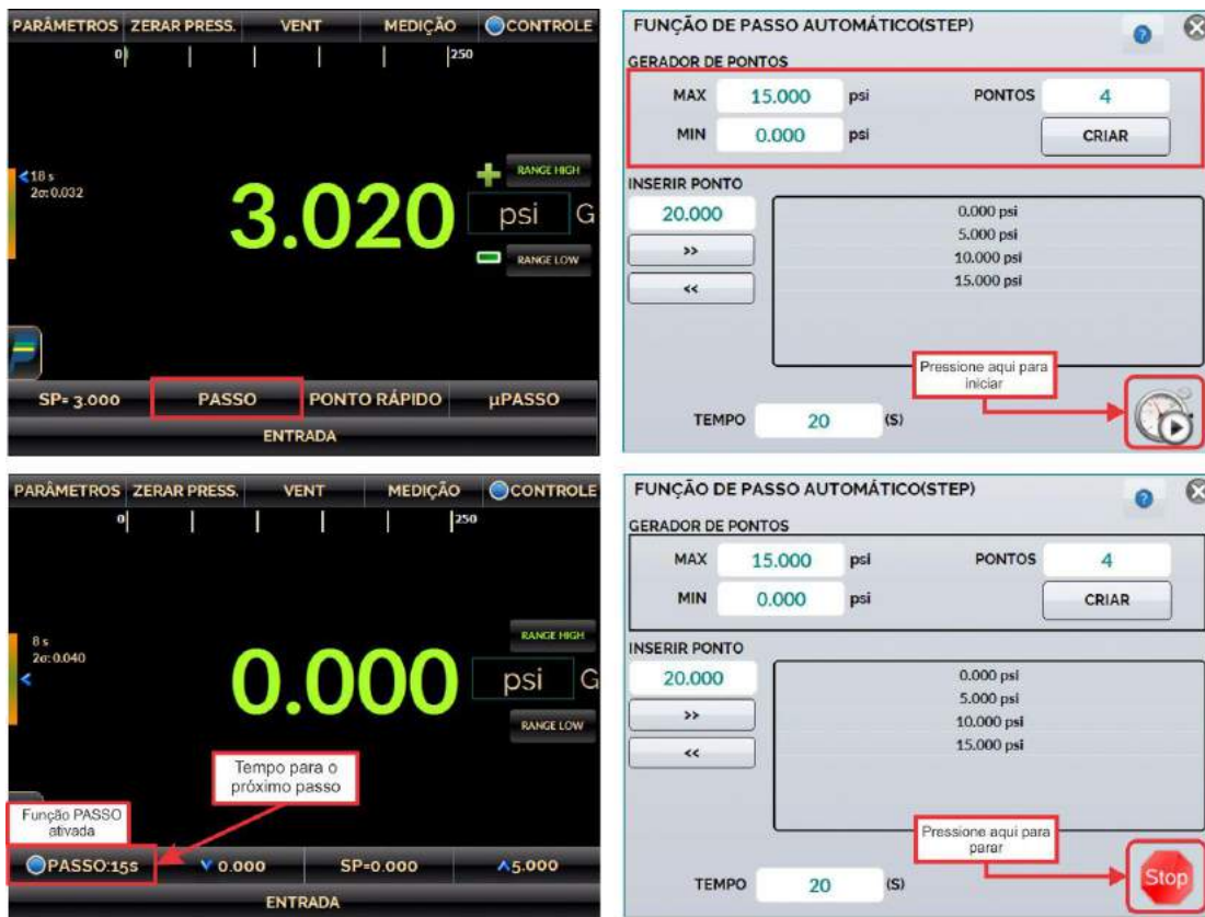
Fig. 29 - Função PASSO (Programa de STEP automático)
