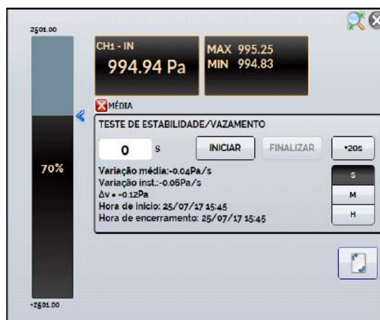
Fig. 54 - Teste de Vazamento/Estabilidade – Resultados
