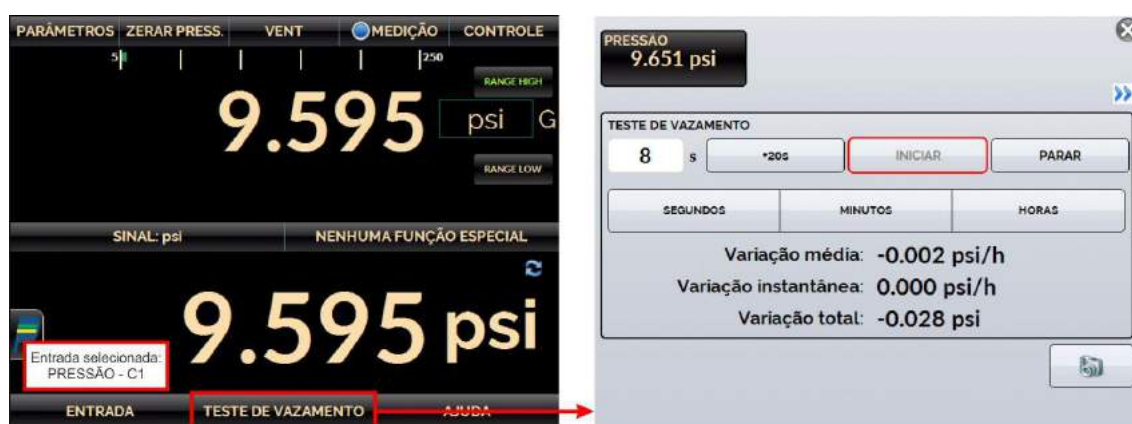
Fig. 51 - Teste de Vazamento
