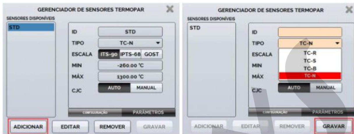
Fig. 08 - Pressiona-se ADICIONAR para alterar o tipo de Referência Externa, selecionar o tipo e GRAVAR
