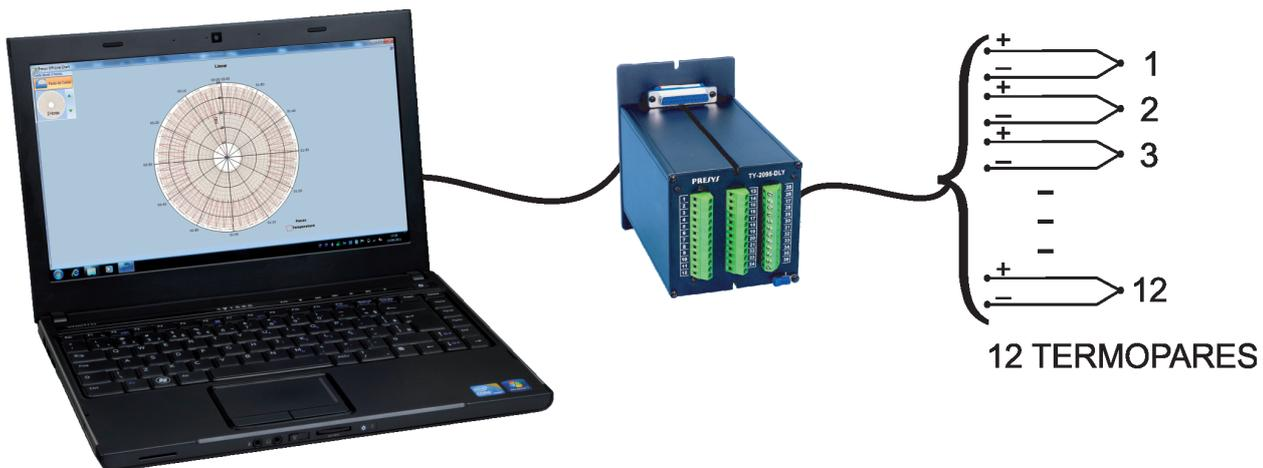
Exemplo de uso, com o TY-2095 medindo 12 pontos de temperatura através de termopares. Pode substituir 12 registradores de uma pena cada ou 6 de duas penas, ou qualquer combinação desejada.
