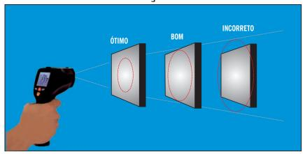
Analisando a figura ao lado, podemos concluir que a área da Fonte de Radiação deve ser maior que a área focal do termômetro.
