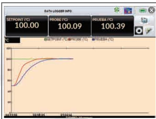
Los Calibradores de la Serie TA le permiten registrar series de mediciones conforme avanza el tiempo para poder ver los datos en formato de gráfico o tabla.
