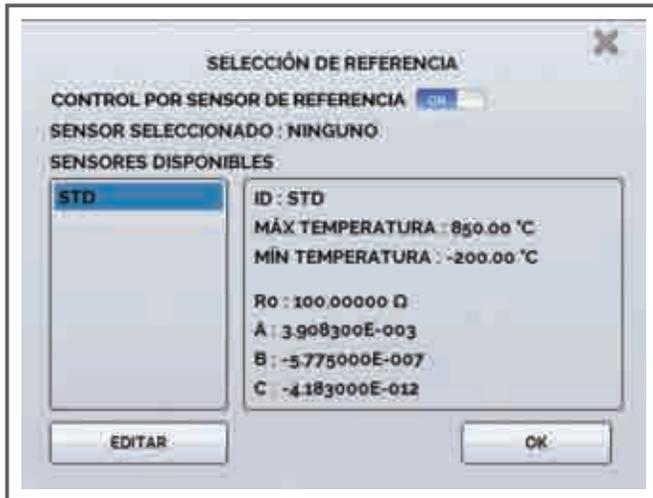
Los bloques secos TA se suministran con una entrada para un sensor de referencia externo que se puede utilizar para mejorar la precisión, eliminar la discrepancia y el efecto de carga o trabajar con inserto de baño de líquido agitado específico, inserto de cuerpo negro o inserto sanitario.
