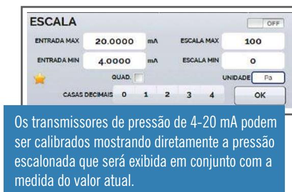
Os transmissores de pressão de 4-20 mA podem ser calibrados mostrando diretamente a pressão escalonada que será exibida em conjunto com a medida do valor atual.
