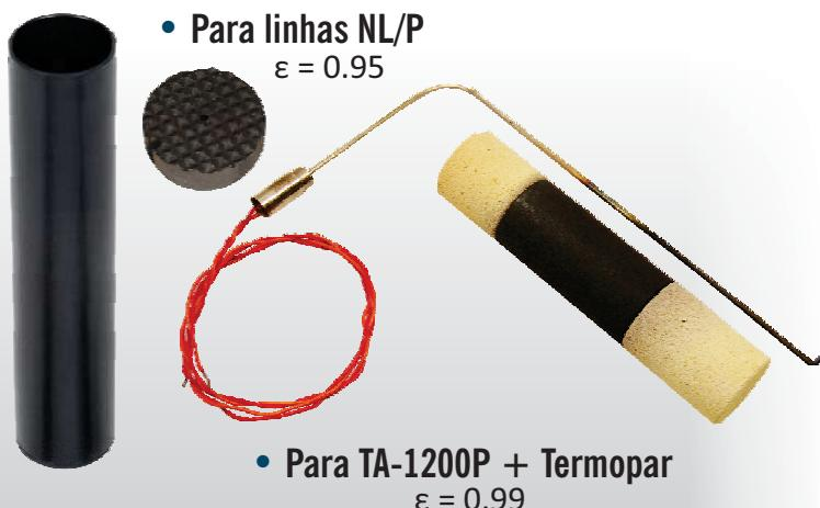
O insert de Corpo Negro transforma o banho térmico TA em um calibrador de termômetros infravermelhos.
