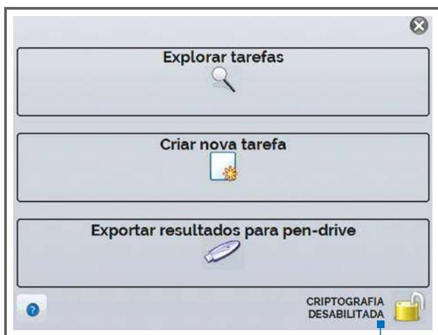
Pode-se criar tarefas usando a tela sensível ao toque ou conectando-se remotamente ao Calibrador TA pelo computador. Outros métodos também são possíveis como o envio de uma tarefa através de sua própria aplicação usando um arquivo XML ou através de uma aplicação do Excel™. O Calibrador TA também pode pegar a tarefa diretamente em um servidor remoto. Todas estas possibilidades estão descritas e documentadas em nosso manual de comunicação.
