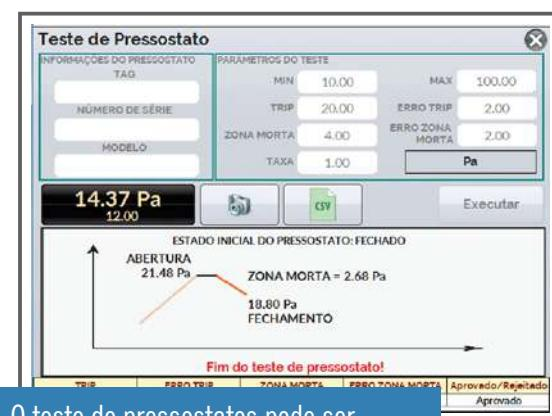
O teste de pressostatos pode ser executado automaticamente.
