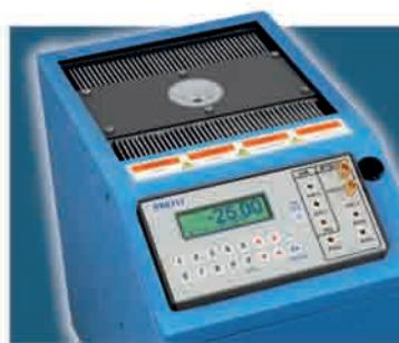
Modelo para calibrar Sensores de Superfície
