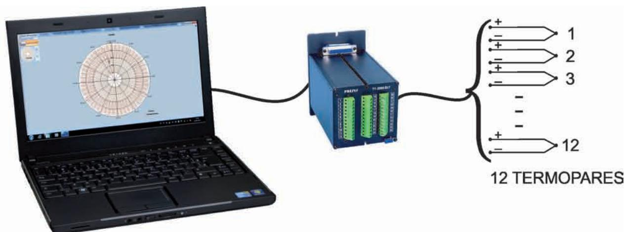
Ejemplo de uso, con el TY-2095 midiendo 12 puntos de temperatura a través de termopares. Puede substituir 12 registradores de una pena cada o 6 de dos penas, o cualquier combinación deseada.
