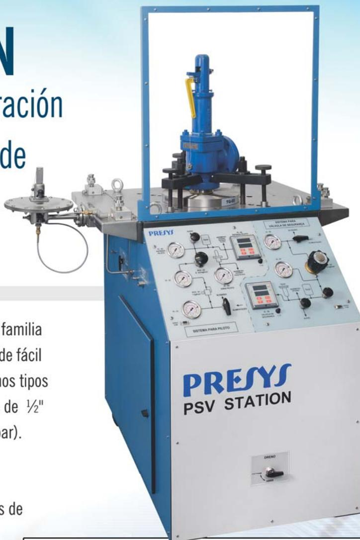
Las Estaciones de PSV de la **PRESYS** son una familia de estaciones portátiles, compactas, digitales y de fácil operación, lo que permite probar y calibrar muchos tipos de válvulas de seguridad y alivio con conexiones de 1/2" hasta 10" y presiones hasta 14.500 psi (1000 bar).
