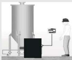
Indicador para uso con célula de carga con entrada de -100 a 100 mV, posee también entrada de contacto seco para habilitar configuración. Posee relés de alarma, salida retransmisora de 4 a 20 mA y comunicación ModBus RTU, RS232 o RS485. Ideal para sistemas de pesaje.
