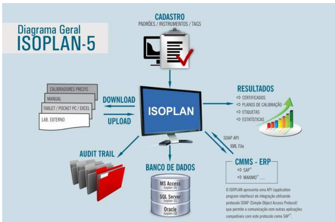
Fig. 55 - Diagrama Geral do Isoplan®-5
